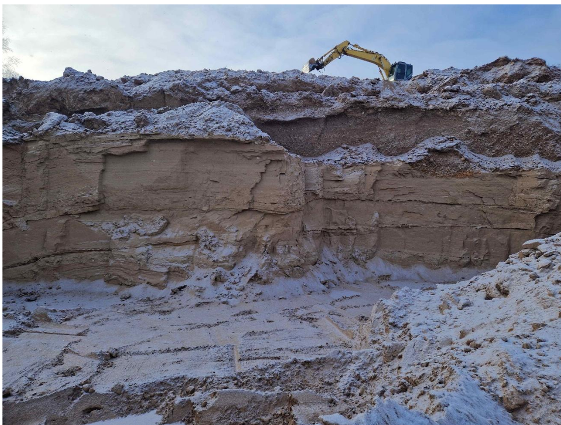
Foto 6.1 Karjääri lõunakülje sein, kus on maavara realiseerimise käigus tuvastatud osaline hea kvaliteediga liiva ja kruusliiva levik
